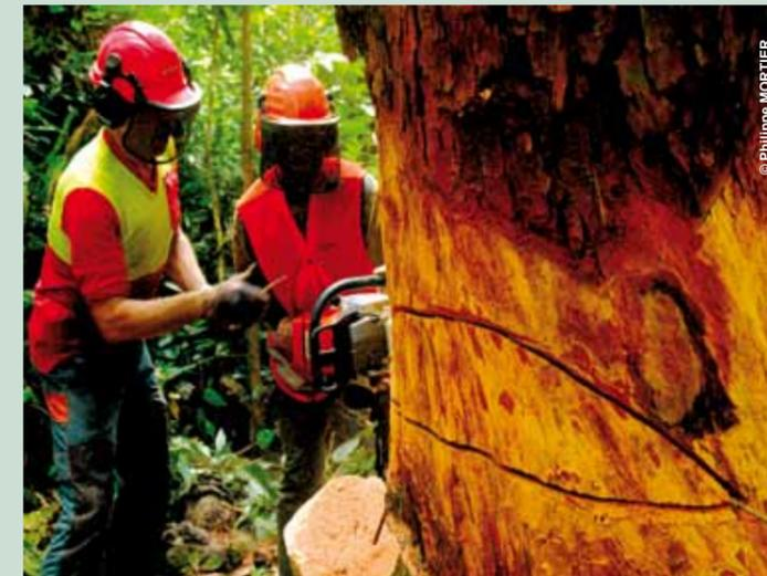
Le formateur (à gauche) expliquant la technique d'abattage contrôlé à un abatteur./Controlled felling instructor (left) explaining the technique to a feller.
